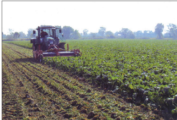
شکل ۲: برگ‌زنی چغندر به‌وسیله دستگاه گریمه FM۳۰۰
